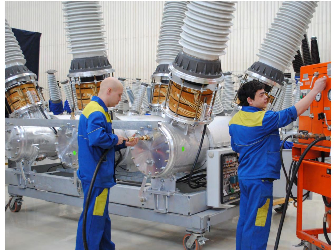
до восьми трансформаторов тока на полюс). Характеристики и комплектация выключателей встроенными трансформаторами тока могут быть выполнены в соответствии с требованиями заказчика
