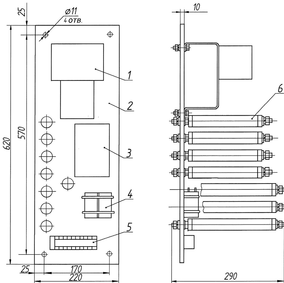
1 – контактор; 2 – панель; 3 – реле блокировки; 4 – конденсатор; 5 – клеммник; 6 – резистор
