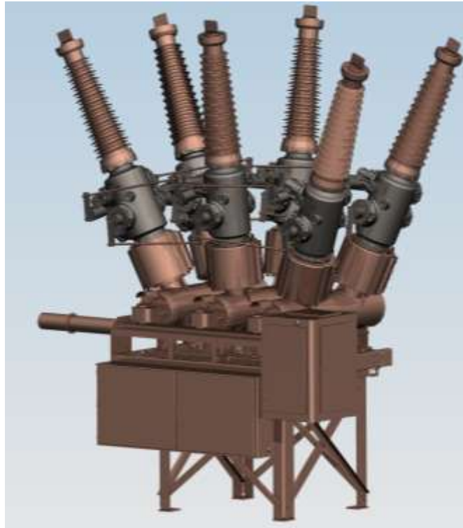
Рисунок 11 – Пример компоновки распреустройства с двумя воздушными вводами
